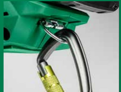
D-Ring zum Befestigen von Lanyards zur Absturzsicherung.
